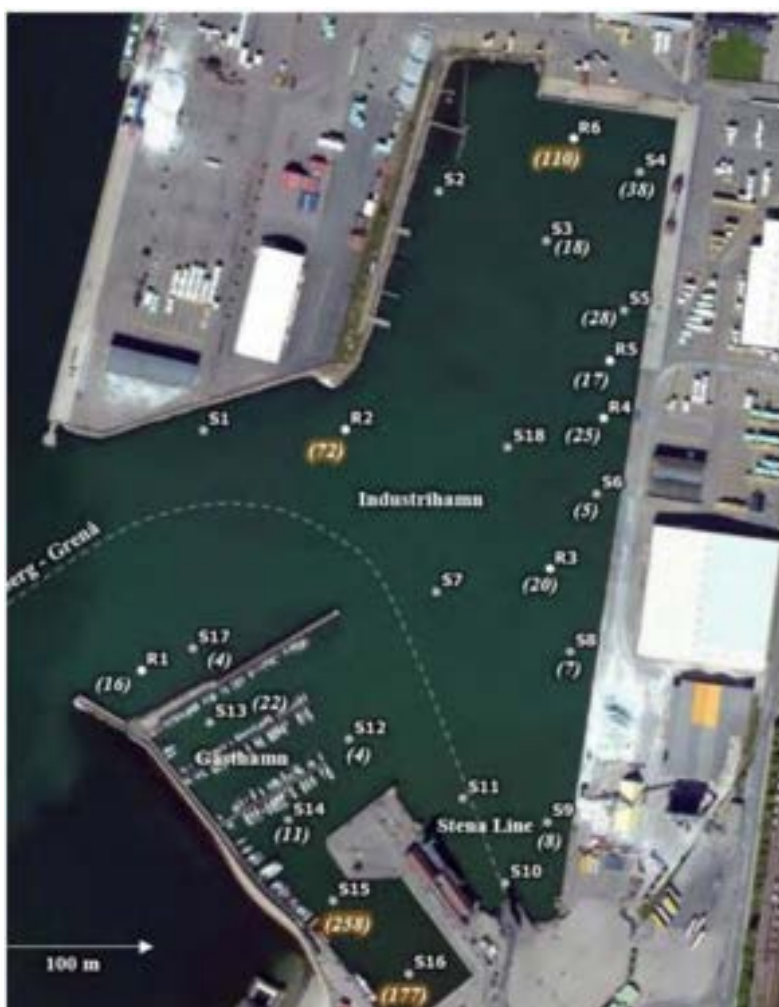
Figur 11. Provtagningspunkter Ramböll 2012 (R1-R6) tillsammans med undersökningar utförda 2017 (S1-S18). Inom parentes anges högst uppmätt halt TBT i resp. punkt (µg/kg TS). Figur: Structor 2017.
