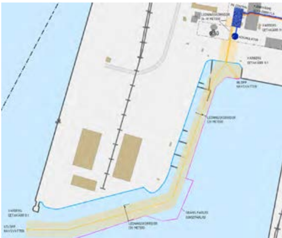
Figur 3. Situationsplan med tänkta platser för inlopp och utlopp av havsvattnet. Den blå markeringen visar lokalisering av fjärrkylcentralen. Figur: FVB Sverige AB.
